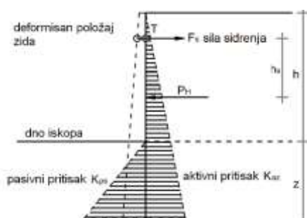
Slika 10.5.35: Raspored pritiska i pomeranja kod jednostruko ankerisanog zida izbušenih šipova
