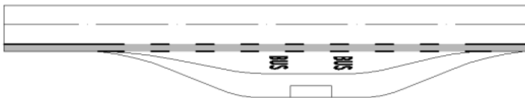
Slika 5.5.16: Uređenje saobraćaja biciklista u području autobuskog stajališta van kolovoza i odvijanje saobraćaja biciklista biciklističkom trakom
