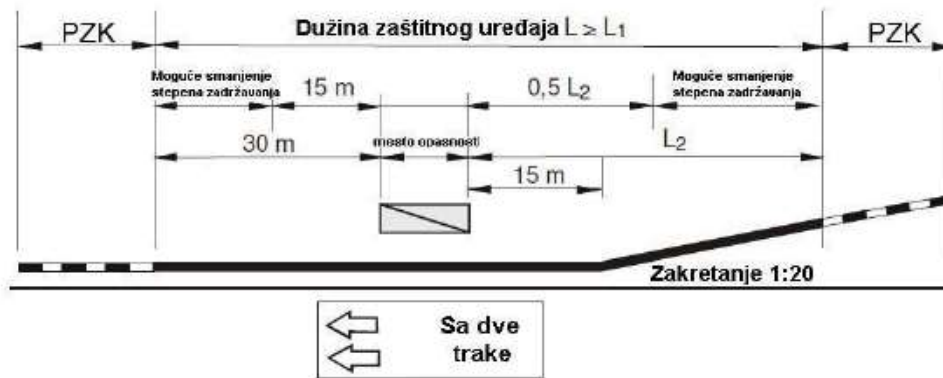
Slika 6.3.26b: Minimalne dužine zaštitnih uređaja pri zakretanju ispred mesta opasnosti (put sa dve kolovozne trake)
