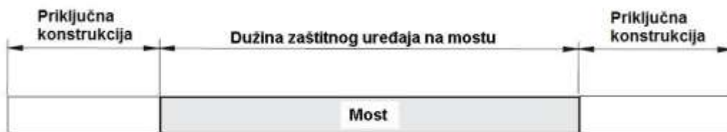
Slika 6.3.40b: Zaštitni uređaj sa priključnom konstrukcijom na mostu
