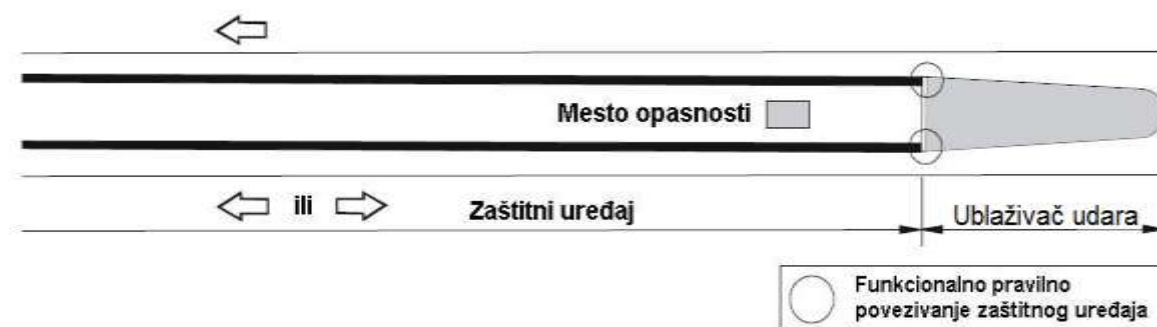
Slika 6.3.39: Ublaživač udara na početku srednjeg ili bočnog razdelnog pojasa
