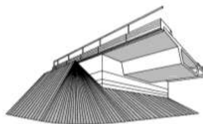
Slika 9.12.8.21: Krajnji stub sa monolitnom rasponskom konstrukcijom
