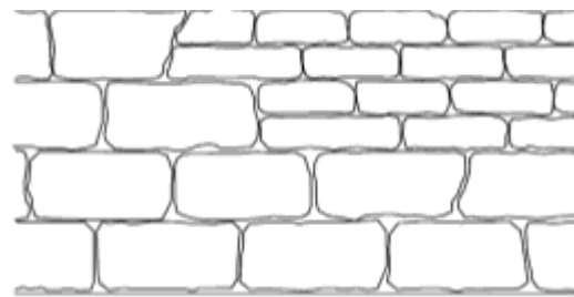
Slika 9.12.8.23: Izgled zida iz lomljenog kamena
