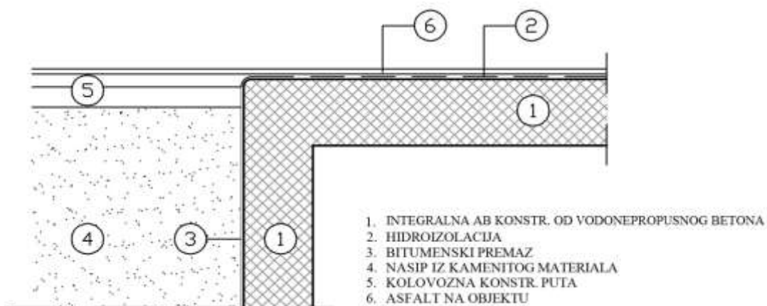
Slika 9.3.12: Prelaz sa integralnog AB mosta dužine do 15 m na nasip puta
