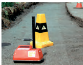
Збијеност, (мерење: 500 m 1 ) (Compactness)
