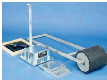
Адхезивност – Виалит тест, (3 тоне) (Vialit test)
