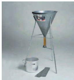
Густина цемента (100 тона) (Bulk density)
