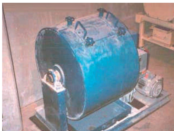
Сл. 5.16 – Апарат за утврђивање отпорности на дробљење и хабање по методи "Лос Анђелес"
