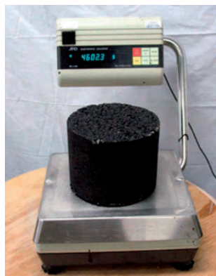
Запреминска маса, ( 200 \text{ m}^3 ) (Bulk Density)
