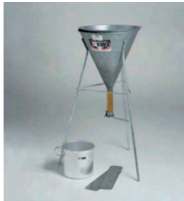
Густина цемента, (100 тона) (Bulk Density of Cement)
