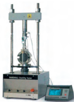
Маршалов тест, (350 тона) (Marshall's Test)
