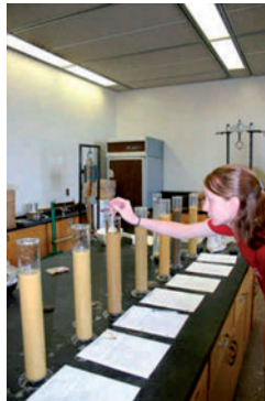
Сл. 1.6 – Лабораторијско испитивање подобности материјала
