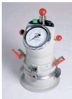
Садржај ваздуха у цементу, (100 тона) (Air in fresh cement)
