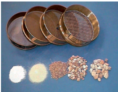
Гранулометријски састав, (100 м 1 ) (Grain-size distribution)
