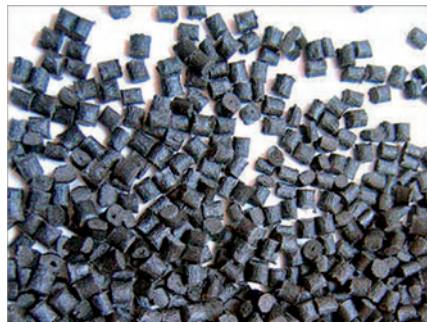
Сл. 5.19 – Полимерне грануле, (Полипропилен - ПП)
