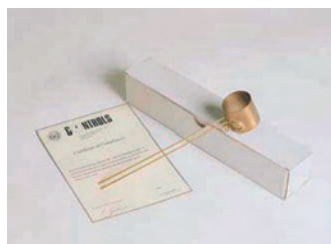
Време везивања и промена запремине, (20 – 25 тона) (Setting time and Volume change)
