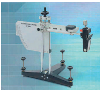
Трење, (1000 м 1 ) (Skidding resistance)
