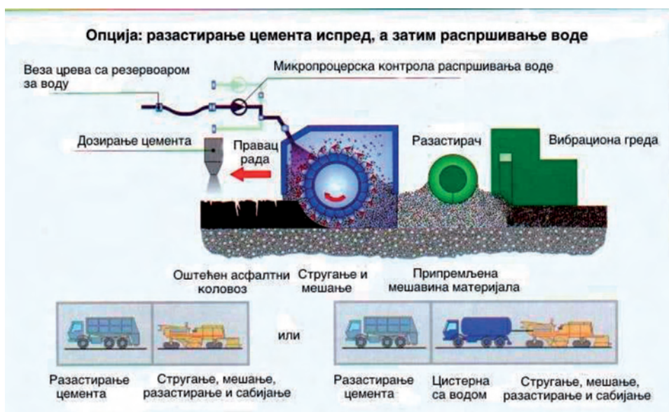
Сл. 5.5 – Технолошки поступак рециклаже по хладном поступку уз додатак цемента
