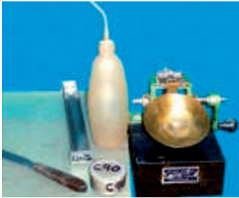
Индекс пластичности, (500 m 1 ), (Plasticity index)
