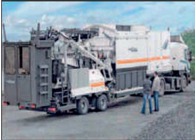
Сл. 5.11 – Механизација за рециклажу по хладном поступку са додатком пенушаваг битумена
