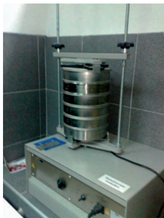
Сл. 5.29 – Просејавање агрегата
