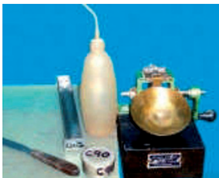
Индекс пластичности, (500 м 1 ), (Plasticity index)
