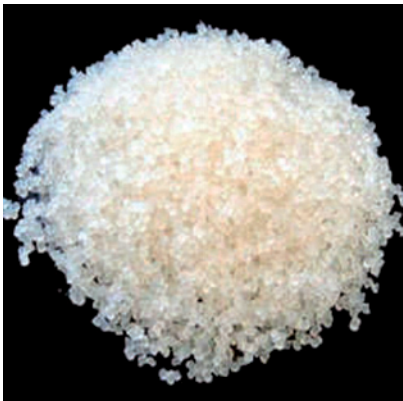
Сл. 5.18 – Полимерне грануле, (Полиетилен - ПЕ)
