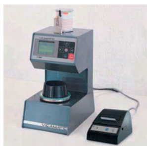
Време везивања, (100 тона) (Setting time)
