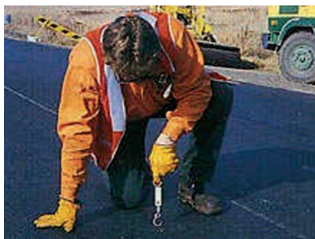
Сл. 4 24 – Контрола прионљивости мреже и асфалтног слоја
