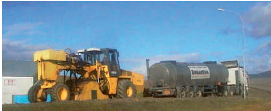
Сл. 5.10 – Механизација за рециклажу по хладном поступку са додатком битуменске емулзије
