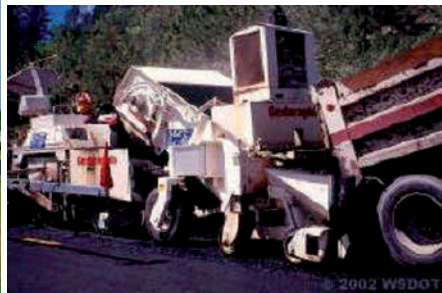
Сл. 5.30 – Машина за претходно мешање асфалтне масе, (између камиона и финишера)
