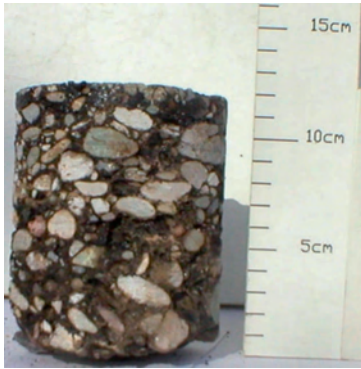
Шупљине у коловозу, ( 200 \text{ m}^1 ) (Voids in pavement)
