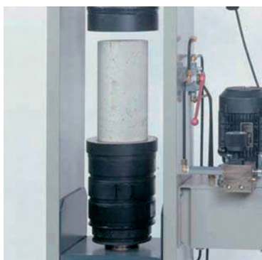
Једноаксијална чврстоћа, (500 м 1 ) (Compressive strength)
