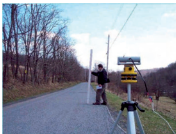
Висински положај, (Leveling position of layer) (Учестаност испитивања: 20-25 m 1 )
