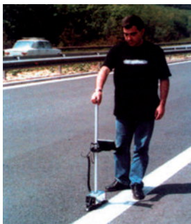
Равност, (мерење на 500 m 1 ), (Evenness)
