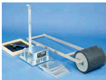
Адхезивност – Виалит тест, (3 тоне) (Vialit test)
