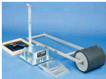
Адхезивност – Виалит тест, (3 тоне) (Vialit test)
