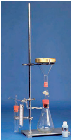
Одређивање количине везане воде, (100 тона) (Water retention value in Cement)
