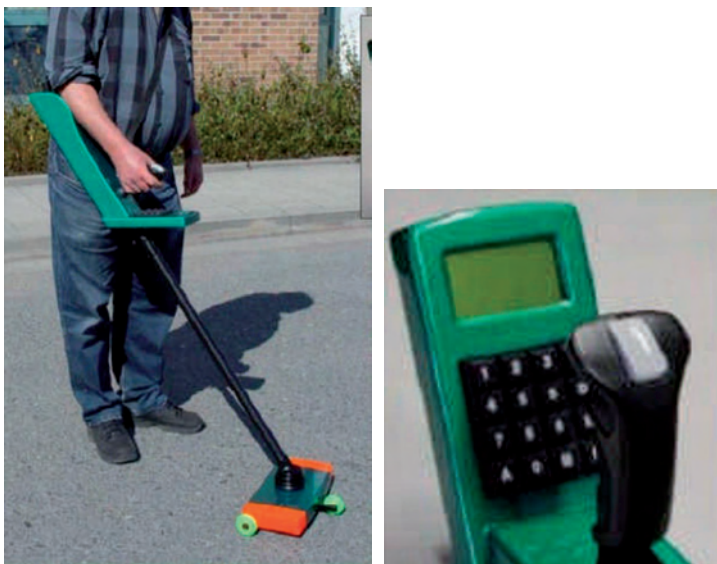
Сл. 5.28 – Мерач дебљине асфалтних слојева
