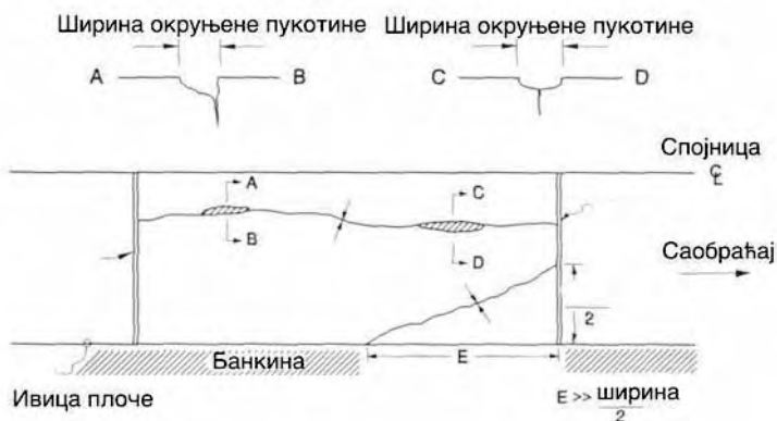
Слика 4.8 Подужне пукотине
