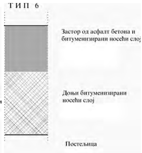
Слика 1.6 Савремене типске коловозне конструкције - ТИП 6
