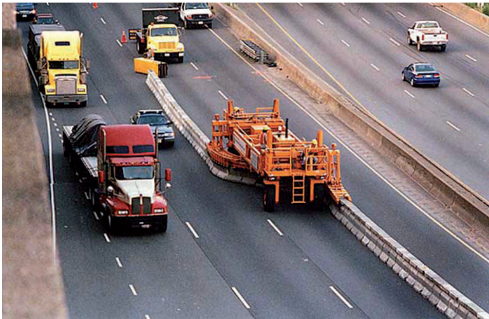
Слика 6.19 Машина за премештање “њу џерси” елемената, “зипер”
