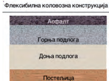
Слика 2.1 Слојеви класичне флексибилне коловозне конструкције
