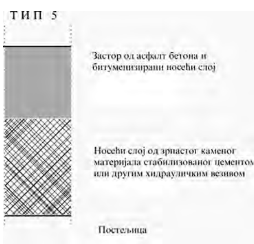
Слика 1.5 Савремене типске коловозне конструкције - ТИП 5
