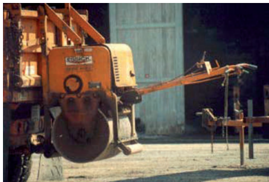
Слика 3.28 Полу - стални поступак (мали вибрациони ваљак)
