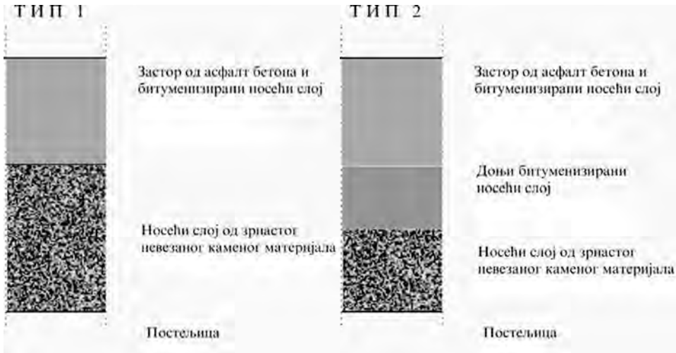
Слика 1.1 Савремене типске коловозне конструкције - ТИП 1
