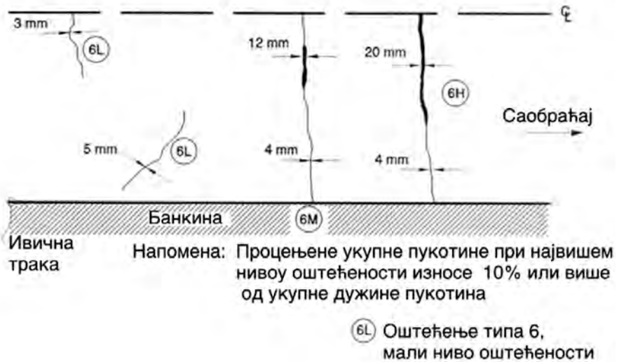
Слика 2.34 Попречне пукотине
