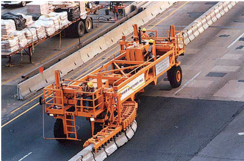
Слика 6.21 Машина за премештање “њу џерси” елемената, “зипер”
