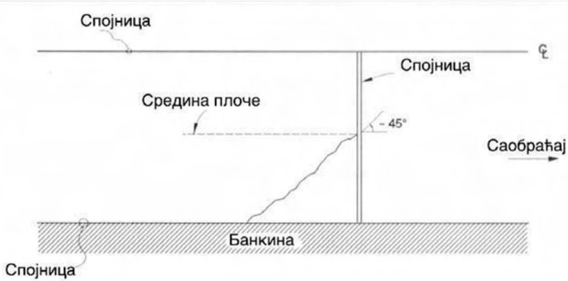
Слика 4.2 Угаона пукотина
