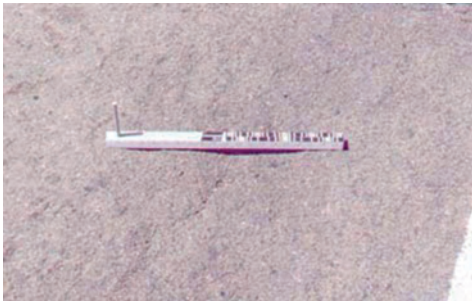
Слика 2.58 Чупање зрна агрегата при малом нивоу оштећености
