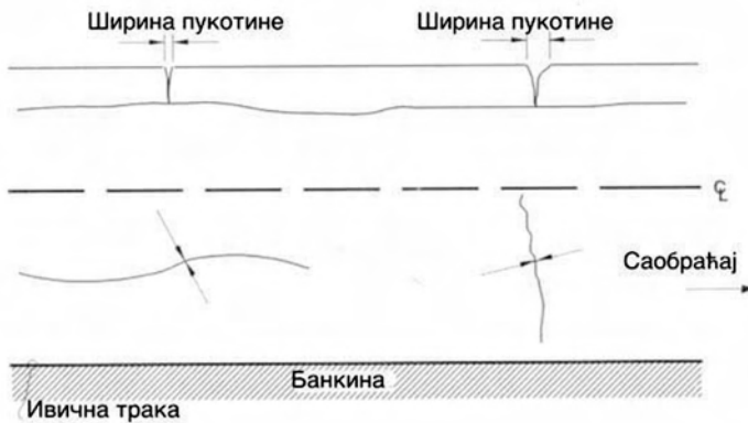
Слика 2.16 Мерење ширине пукотине код асфалт бетонских застора
