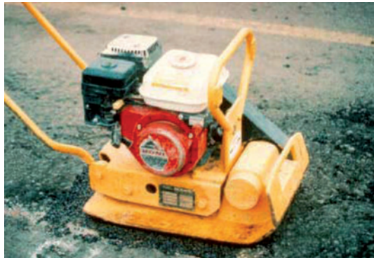
Слика 3.27 Полу - стални поступак (збијање вибрационом плочом)
