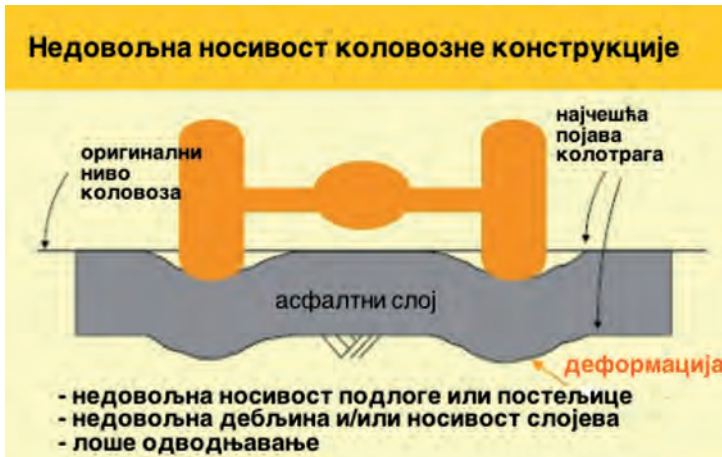
Слика 2.7 Шта је узрок колотрага?
