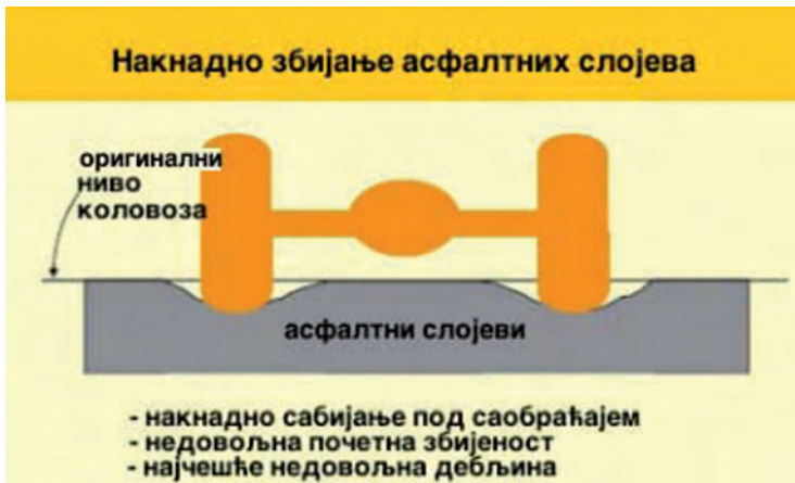
Слика 2.8 Шта је узрок колотрага?
