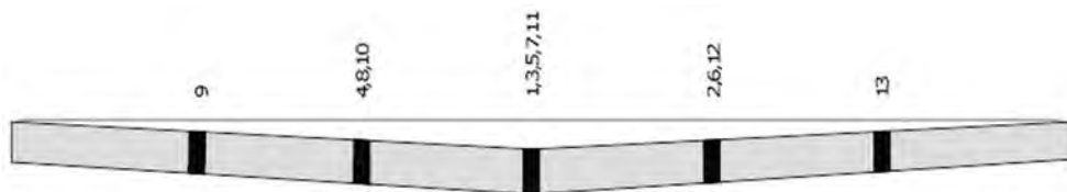
Слика 5.7 Са инјектирањем се креће од најниже тачке
