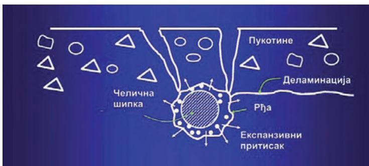
Слика 5.43 Корозија арматуре
