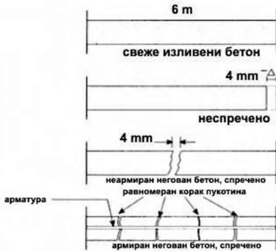
Слика 5.46 Шема прслина бетонске плоче
