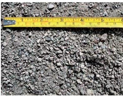
Слика 3.92 Слојеви од невезаног агрегата
