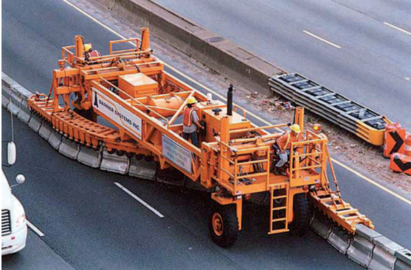
Слика 6.20 Машина за премештање “њу џерси” елемената, “зипер”
