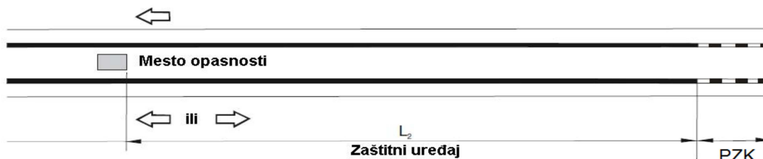
Слика 17: Заштитни уређаји са једностраним деловањем са почетном и завршном конструкцијом на почетку средњих или бочних разделних појасева
