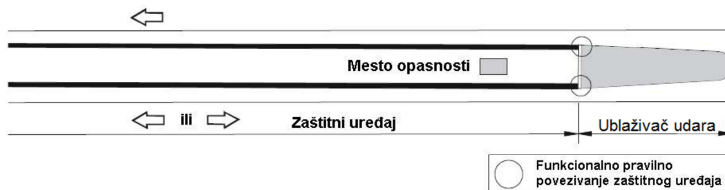
Слика 18: Ублаживач удара на почетку средњег или бочног разделног појаса
