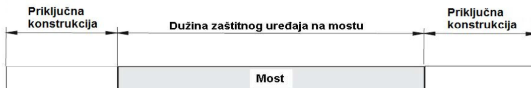
Слика 19б: Заштитни уређај са прикључном конструкцијом на мосту
