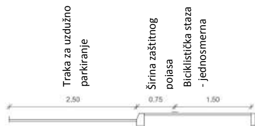
Slika 5.6.7: Širina zaštitnog pojasa uz traku za uzdužno parkiranje
