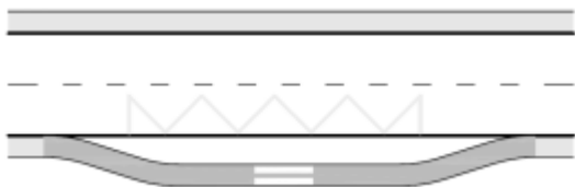
Slika 5.6.40: Autobusko stajalište na kolovozu, biciklistička staza
