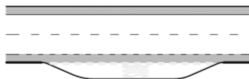
Slika 5.6.39: Autobusko stajalište u niši, biciklistička traka
