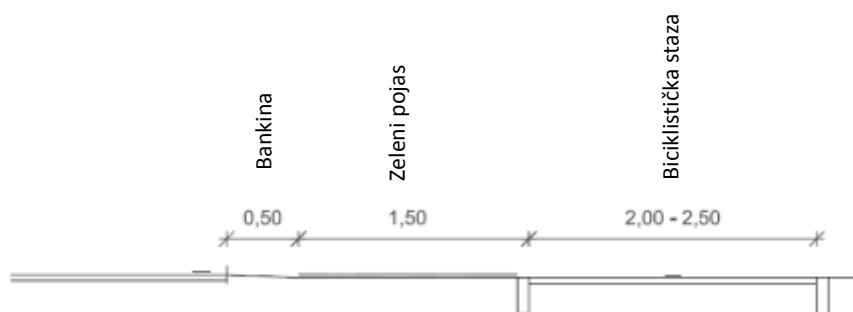
Slika 5.6.8: Širina zaštitnog pojasa na biciklističkoj stazi unutar naselja
