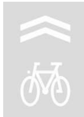
Slika 5.6.2: Horizontalna oznaka – upozorenje vozačima: Biciklisti na kolovozu
