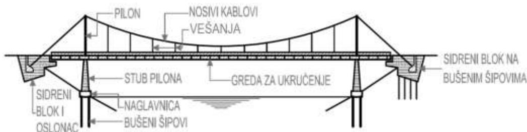
Slika 9.1.7: Osnovni nazivi na konstrukciji visećeg mosta
