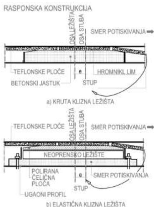
Slika 9.11.12: Pomoćna klizna ležišta i teflonske ploče
