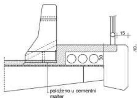
Slika 9.12.6.23: Primer izrade asfaltna dilatacije uz BSO
