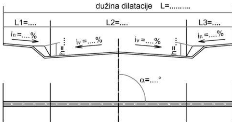
Slika 9.12.6.17: Najvažnije dimenzije na crtežu dilatacije
