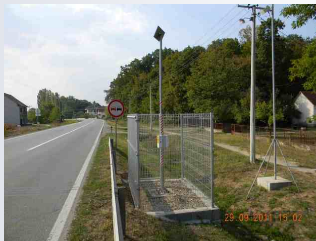
Аутоматски бројачи саобраћаја, тип QLTC 10с и EIS
