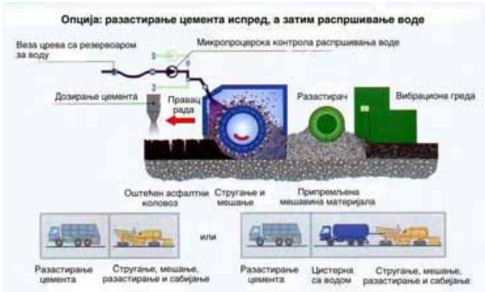
Слика 12.18 Разастирање цемента испред рециклажне машине
