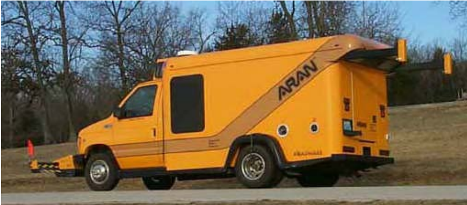
Слика 16.2. Возило ARAN за прикупљање података о коловозу
