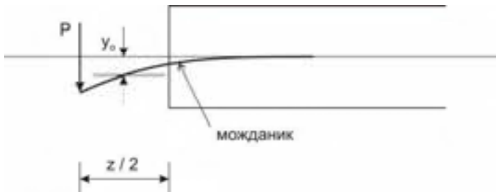
Слика 8.14 Шема деформације можданика под оптерећењем
