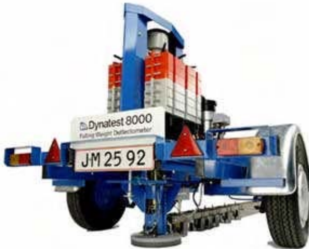
Слика 17.4 FWD (Falling Weight Deflectometer) уређај за мерење угиба са падајућим теретом
