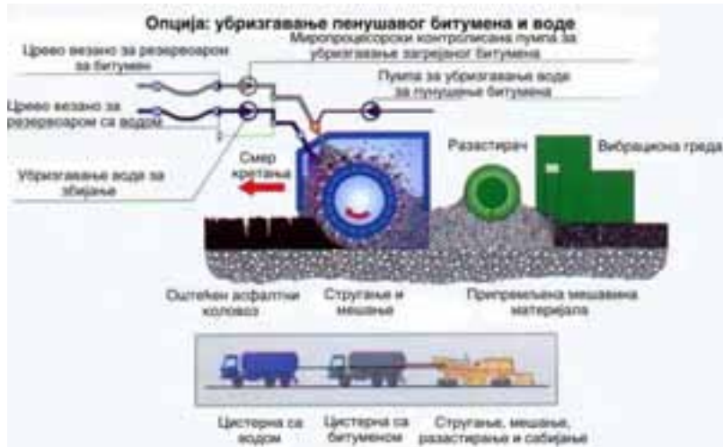
Слика 12.22 Убризгавање пенишаваг битумена и воде
