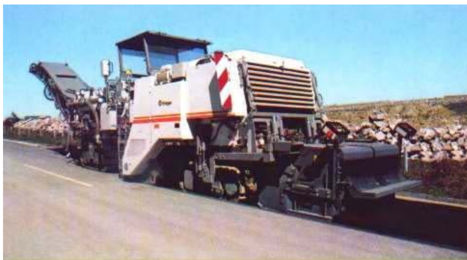
Слика 12.23 Опција када машина ради као стругач - глодалица
